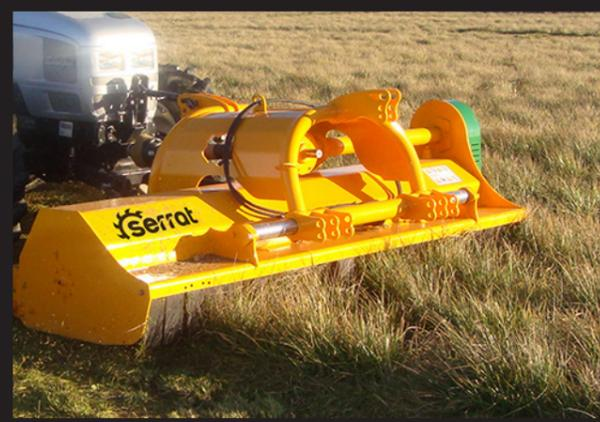
Мульчер молотков, для устранения остатков обрезки до 80 мм и поддержания растительного покрова. Идеально подходит для регенерации лугов и лугов. Ротор POLSER 450-500 мм диаметром. Отличные результаты в промышленном озеленении и обслуживании бордюров. Его реверсивная и подвижная конфигурация позволяет хорошо управлять машиной как в заднем подъемнике, так и в передней части в реверсивных тракторах, не допуская протискивания материала на мульчу.
