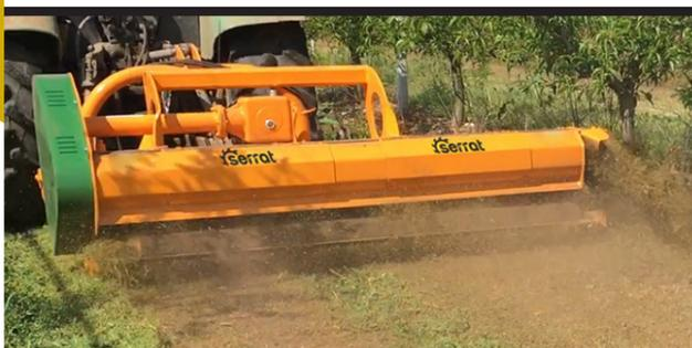
Новый мульчер EVOLUTION GREEN, за один проход и при нормальной скорости, способен косить и выбрасывать траву к основаниям фруктовых деревьев, без каких-либо дополнительных затрат времени на работы и получая тройную выгоду:
