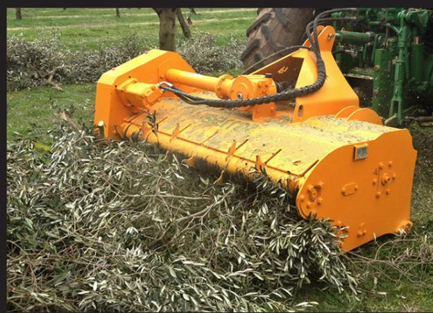
Мульчер с реверсивным гидравлическим питателем, идеально подходит для обрезки виноградников, десертного винограда, каштанов, оливковых деревьев, миндальных деревьев, цитрусовых, грецких орехов, лещины и т. Д. Для тракторов от 60 до 120 л.с. Машина для тяжелых работ, с необходимостью складировать очень тонкие остатки в этой области, избегая возможных эпидемий и помогая их устранению, для последующих процессов. Имеет ротор зубчатых скалывателей, пересекающихся с фиксированным небом.
