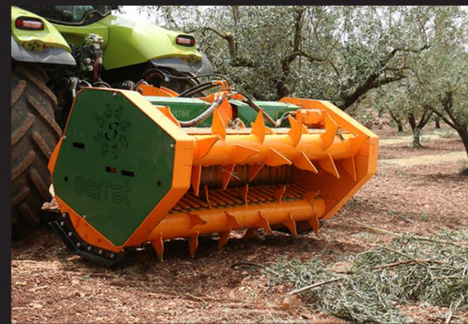
Мульчер с реверсивным гидравлическим питателем для тракторов мощностью от 220 до 350 л.с., идеально подходит для дерева диаметром до 250 мм. Машина для тяжелых работ, с необходимостью размещения очень тонких остатков на участке, избегая возможных эпидемий и помогая их устранению, для последующих процессов. У этого есть ротор зубчатых скалывателей, пересекающихся с фиксированным небом, названным RHENDUEL.
