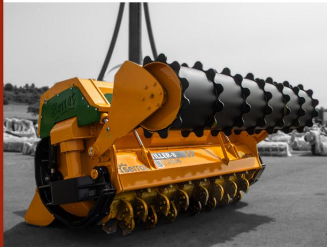
Машина для проведения ротовации на глубину до 600 мм, для тракторов от 400 до 500 л.с.
