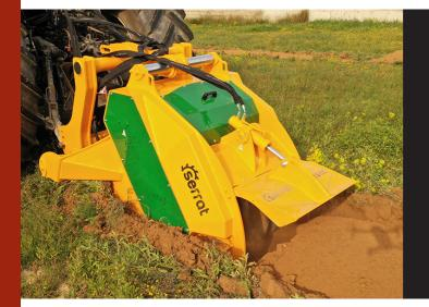
Машина для обработки почвы на глубину до 400-500 мм, для тракторов от 200 до 350 л.с. Превращает земельные угодья с пнями и камнями в землю для возделывания, оставляя почву рыхлой и подготовленной к последующим работам.
