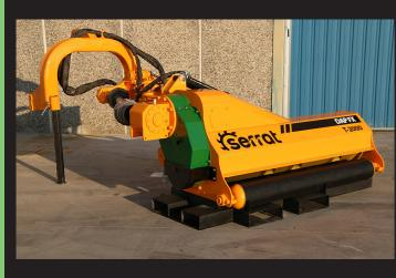
Смещенный мульчер высокой дальности с лесным ротором, для работ на сельскохозяйственных полях, берегах, шоссе, каналах, дорогах и др. Очищает общественные работы для тракторов между 140-200 л.с. Он включает в себя систему безопасности благодаря клапану, расположенному в цилиндре подъема рычага. Угол наклона + 90º / -50⁰. Potop POLSER + Ø 550 мм с лесным молотом
