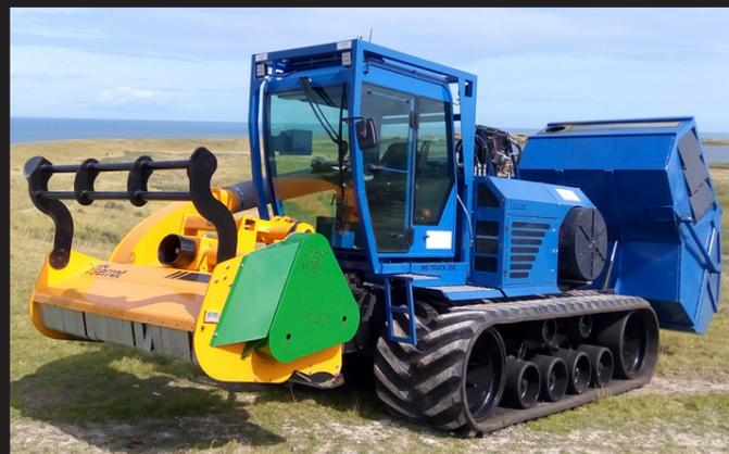
Мульчер Biosylva, всего за одну операцию и с обычной скоростью, может срезать и запускать траву и ветви диаметром до 100 мм в осадок, чтобы удалить их с земли. С помощью этого специального приложения SERRAT хочет внести свой вклад в поддержание природных территорий, обочин и, прежде всего, водно-болотных угодий, экспортируя остатки непосредственно в хранилище или прицеп, а затем использовать их для производства компоста или биогаза.
